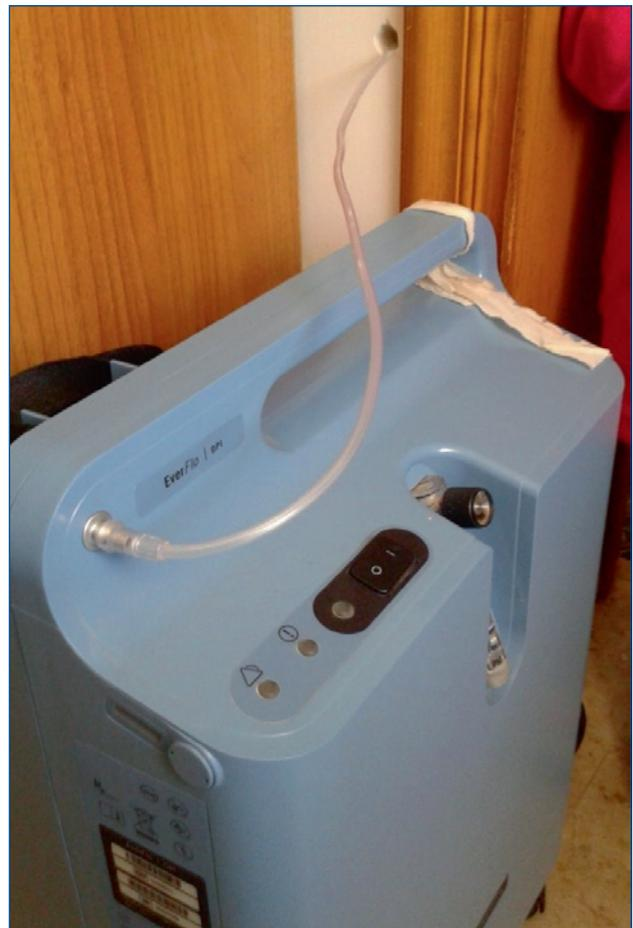
**Figura 1.** Soluzione esterna per la rumorosità del concentratore.
